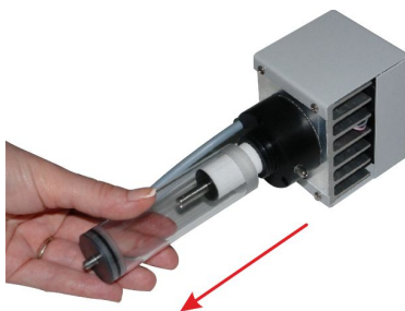
Рис. 13. Снятие ловушки для конденсата с блока осушки MD2.
