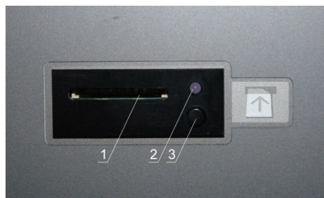
Рис. 12. Модуль хранения информации MMC. 1 – отсек для карты памяти; 2 – световой индикатор; 3 – кнопка остановки записи.
