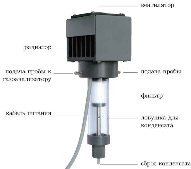
Рис. 3. Блок осушки MD2.
